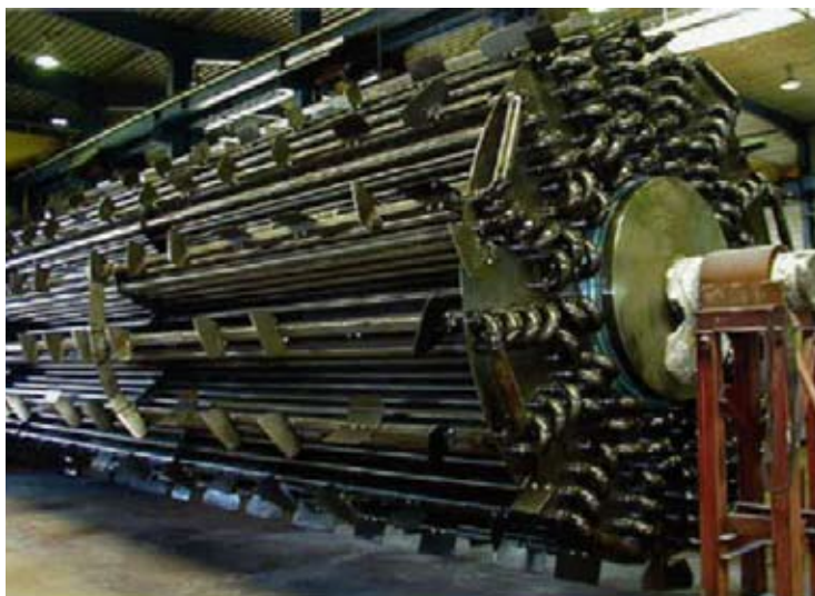
Рис. 4. Внутреннее устройство барабанной паровой сушилки [2]
